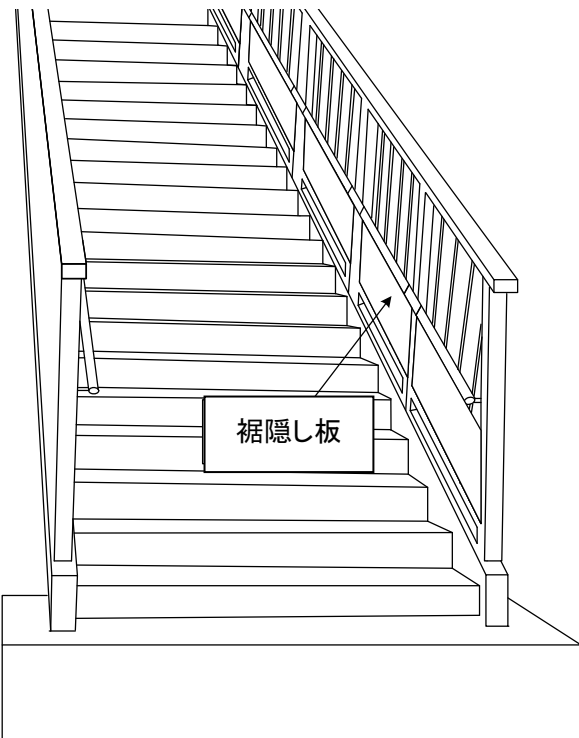
図 1 2 横断歩道橋部位区分 (3) 通路及び添架物 その 2)
